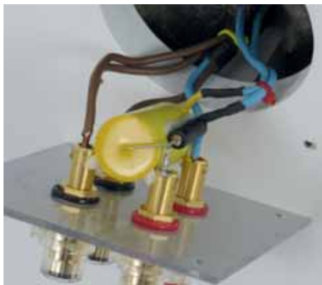
Il condensatore in serie al tweeter.
