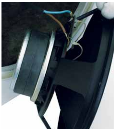
Il midwoofer in configurazione dipolare con il tweeter con il magnete in evidenza.
