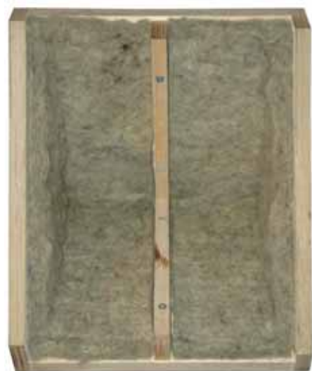
All'interno, si possono apprezzare i setti in multistrato di betulla, lo stesso materiale del cabinet, si nota la lana di pecora scelta come materiale smorzante interno.
